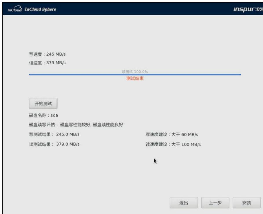
图 4.5- 21 磁盘性能测试
